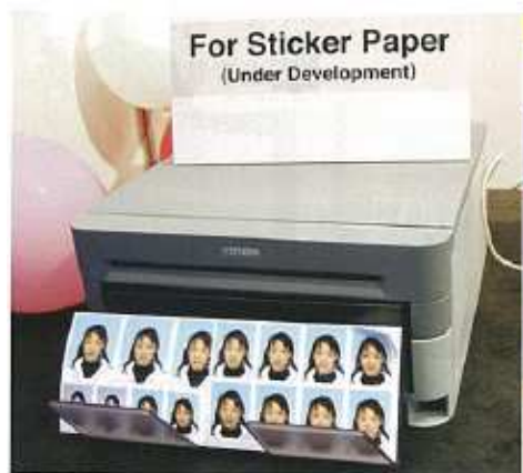
アルテックが参考出品した『Sticker Paper』。プリンターはシチズン製でヘッドとカッターが内蔵されている
